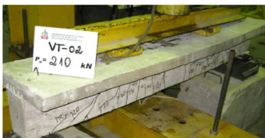
Figura 14: Carga V_u e modo de ruptura da viga VT – 02. FONTE: Próprio autor (2015).
