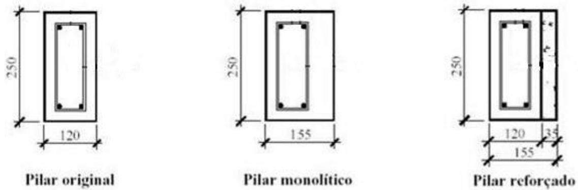
Figura 13 – Características das seções transversais dos pilares ensaiados por NASCIMENTO (2009)
