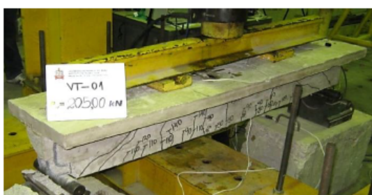
FIGURA 13: Carga V_u e modo de ruptura da viga VT – 01. FONTE: Próprio autor (2015).
