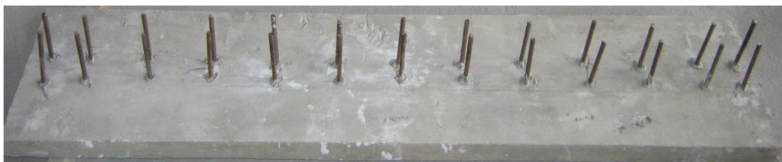
Figura 30 – Conectores de cisalhamento fixados na mesa com adesivo estrutural, OLIVEIRA (2015)
