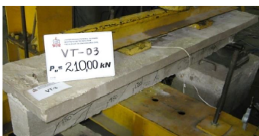
Figura 15: Carga V_u e modo de ruptura da viga VT – 03. FONTE: Próprio autor (2015).
