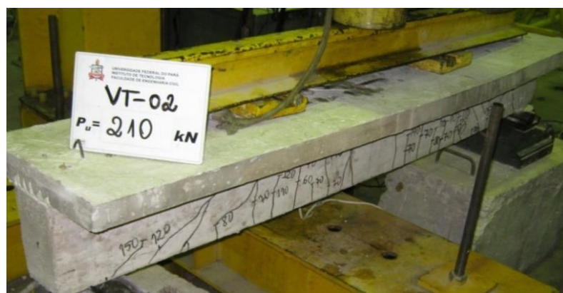
Figura 35 – Carga V_u modo de ruptura da viga VT – 02, Oliveira (2015)
