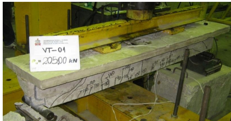
Figura 34 – Carga V_u modo de ruptura da viga VT – 01, Oliveira (2015)
