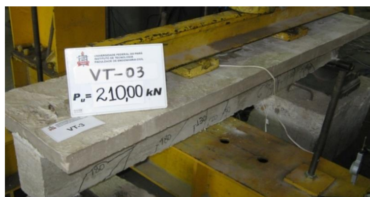
Figura 36 – Carga V_u modo de ruptura da viga VT – 03, Oliveira (2015)
