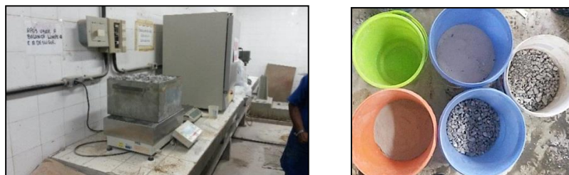
Figura 18 - Detalhe da pesagem e dosagem dos materiais para produção dos concretos
