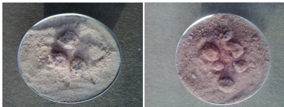
Figura 1.4 – Amostras de areia de cor branca e de cor rósea, coletada em jazida.
