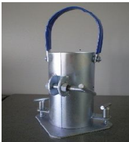
Figura 3.2 - Molde cilíndrico de 100 mm x 200 mm.
