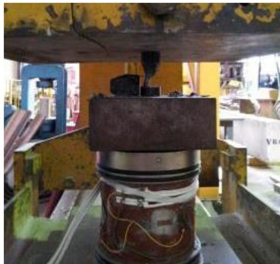
Figura 13. Ruptura da amostra sob compressão uniaxial.
