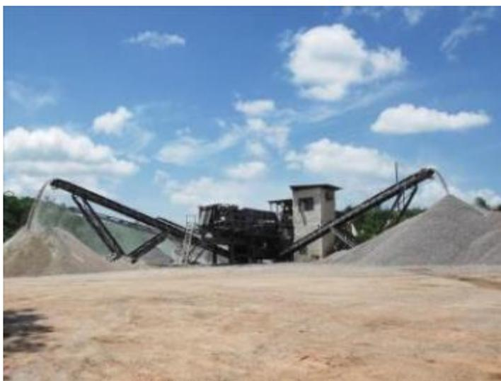
Figura 14. Britador do destacamento Rurópolis, pertencente ao órgão executor da obra BR-163.
