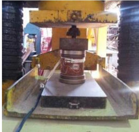
Figura 12. Ensaio de compressão uniaxial realizado em amostra da rocha gabro da “serra do Inajá”.
