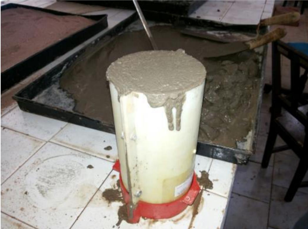
Figura 16. Moldagem dos corpos-de-prova.
