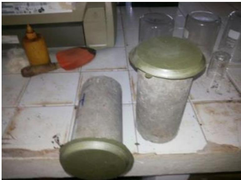
Figura 17. Corpos-de-prova preparados para o ensaio – 8º BEC
