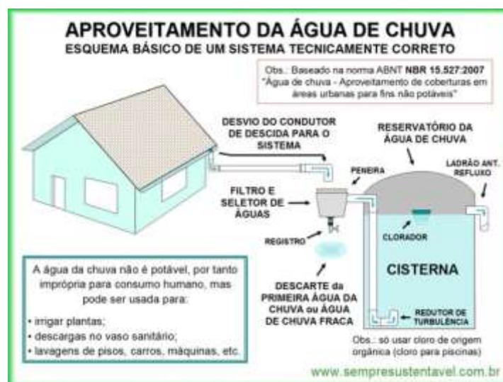
Figura 9: Esquema de um sistema de coleta e armazenagem de água pluvial
