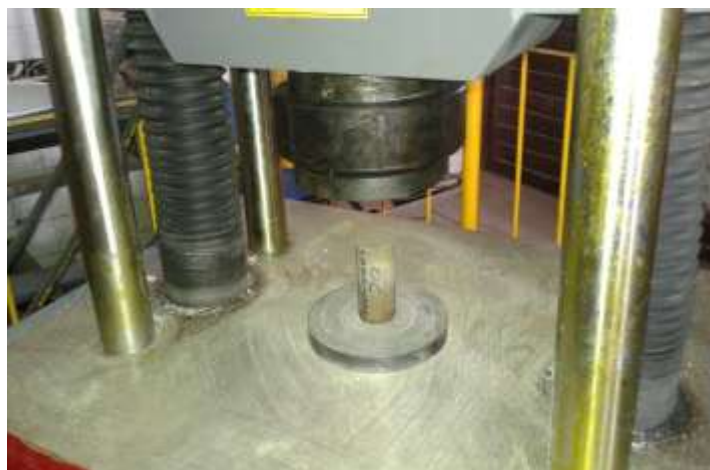
Figura 12: Ensaio de corpo-de-prova à compressão.
