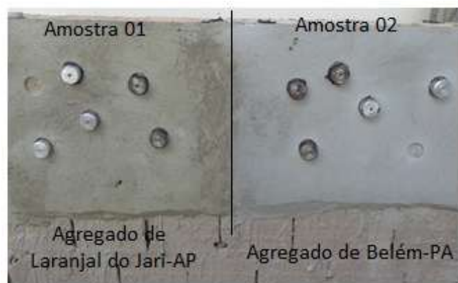
Figura 13 – Amostras para o ensaio de aderência.
