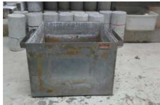
Figura 7: Imagem do recipiente utilizado para o ensaio da massa unitária.
