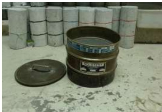
Figura 10 – Peneiras utilizadas no ensaio de teor de materiais pulverulentos.
