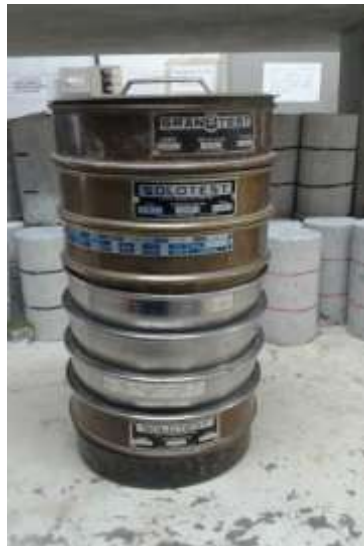
Figura 9 – Peneirador mecânico com peneiras da série normal
