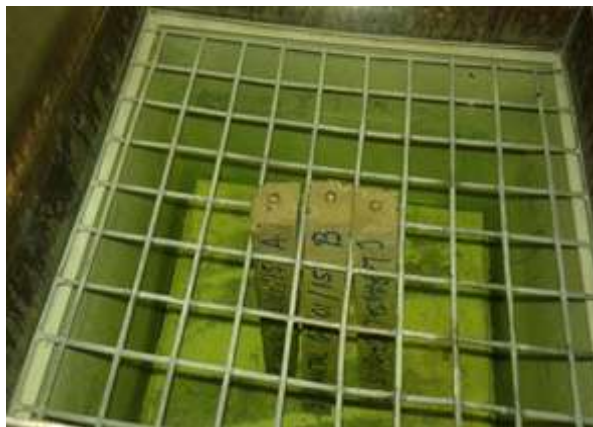
Figura 14 – Imagem das amostras para o ensaio de reação álcali-agregado (RAA).
