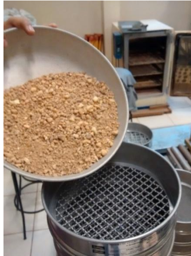
FIG 10 - Material sendo colocado na série de peneiras. Fonte: Laise Quemel.
