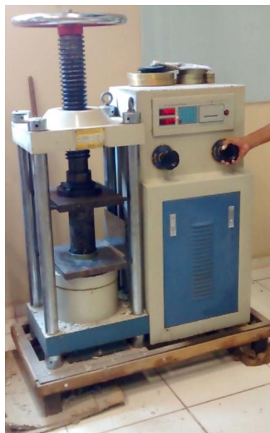
FIG 22 – Máquina de compressão para mensurar a resistência dos corpos de prova. Fonte: Laise Quemel, 2015.
