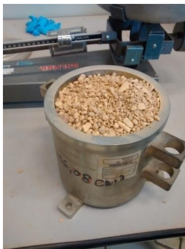
FIG 12 – Análise da massa unitária, com um frasco previamente mensurado. Fonte: Laise Quemel.
