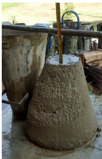
FIG 25 – 2º Resultado do teste de slump – seixo in natura. Fonte: Laise Quemel
