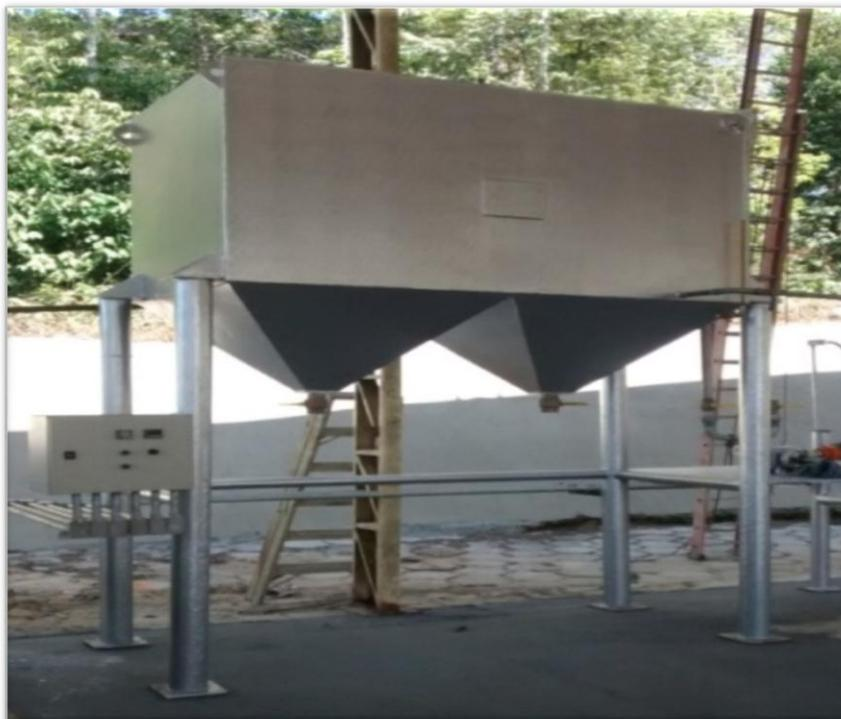
Figura 2 - Taque Reservatório de Alimentação da matéria-prima.
