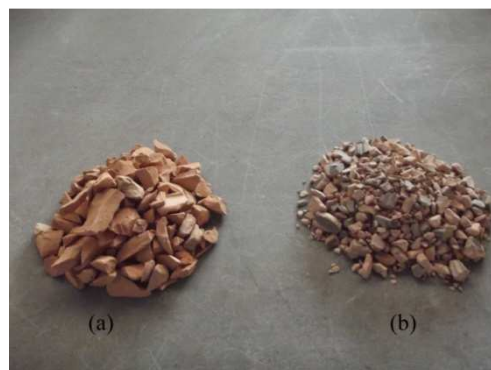
Figura 28 – Resíduo de cerâmica vermelha: a) Material antes do ensaio e b) material após o ensaio
