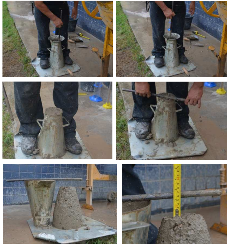
Figura 38 - Execução do abatimento de tronco de cone (Slump test)
