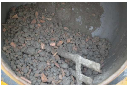
Figura 48 - Momento da mistura (TCV-30) do aglomerante e dos agregados graúdos na proporção de 70% de agregado graúdo natural e 30 de RVC
