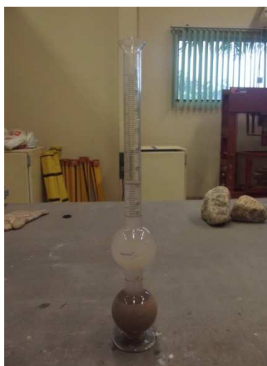
Figura 21 - Determinação da massa específica do agregado miúdo por meio do frasco de Chapman
