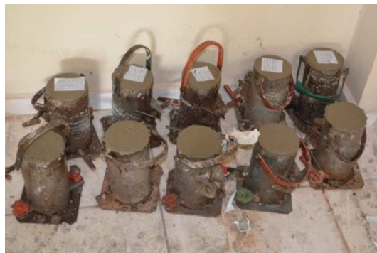
Figura 40 – Corpos-de-prova protegidos, nas primeiras horas para que não sofram influência das intempéries
