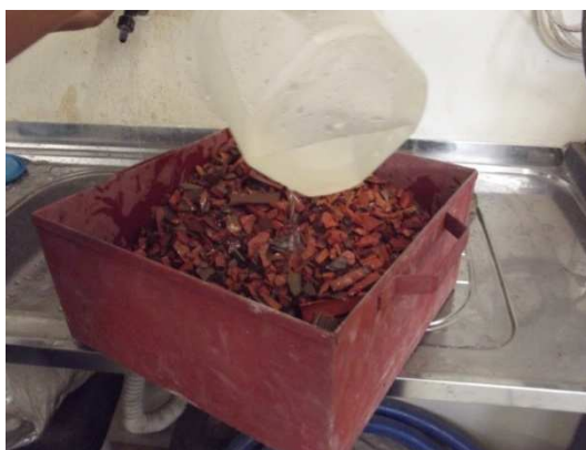
Figura 36 - Adição de água em função da absorção de água do agregado graúdo do resíduo da indústria cerâmica vermelha (RCV)
