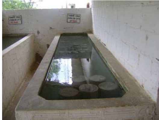
Figura 41 – Corpos-de-prova imersos em água saturada de hidróxido de cálcio ( http://2.bp.blogspot.com/_OSuuUYX1BHk/S5zNMRkm5OI/AAAAAAAAAvC/PwJky-j9-TE/s400/DSC08886.JPG )
