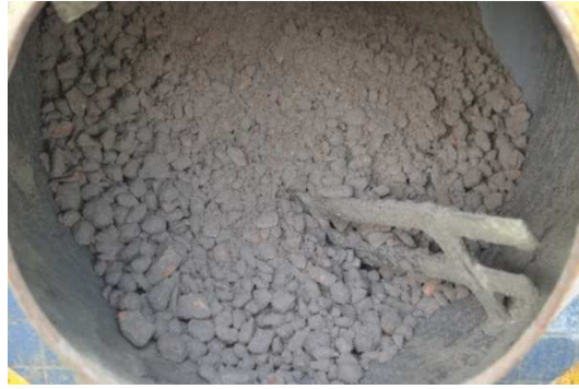
Figura 49 - Observa-se o aspecto de “farofa” da mistura TCV-30
