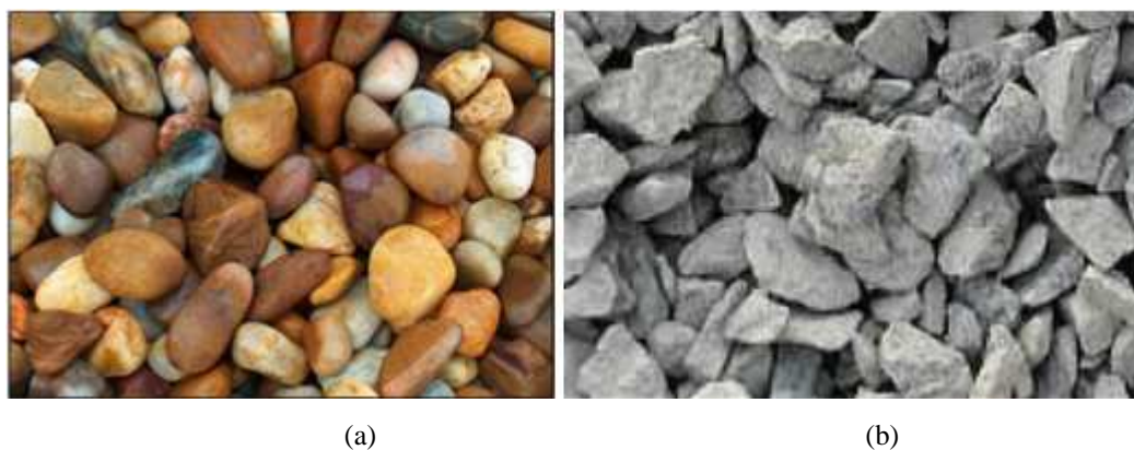
Figura 4 - a) Seixo rolado do fundo de rios; (b) brita a partir do desmonte de rochas através de britagem (FREITAS JUNIOR, 2003)
