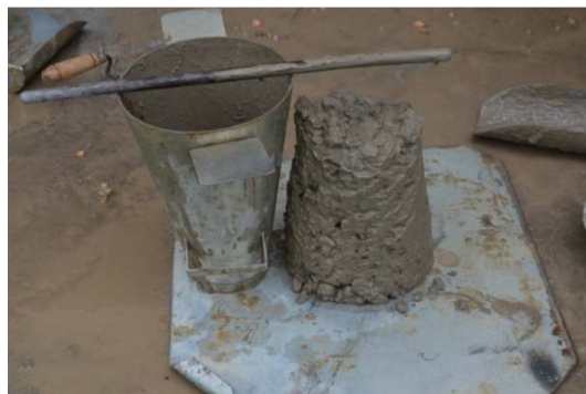
Figura 50 - Aspecto mais coeso das misturas com substituição do agregado natural pelo agregado RCV após a retirada da betoneira para execução do abatimento de tronco de cone.
