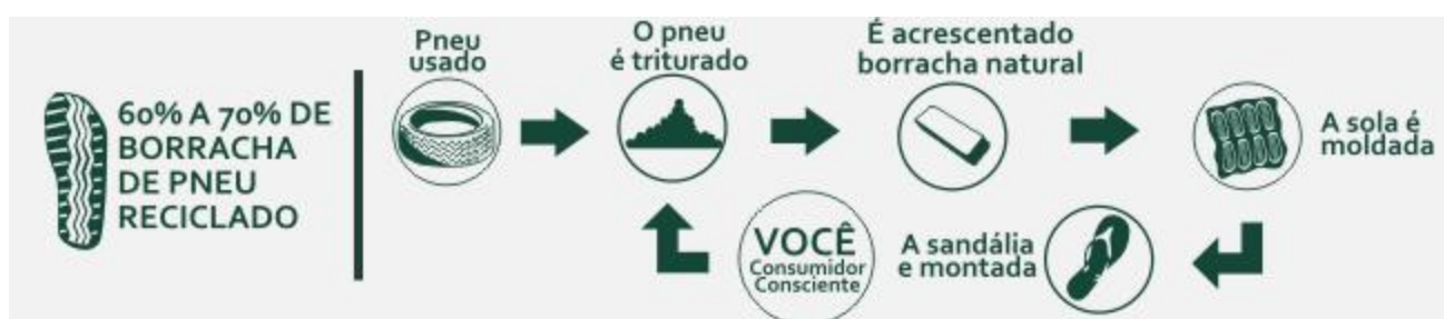
Figura 3: Ciclo de aproveitamento de pneus pela Goóc
