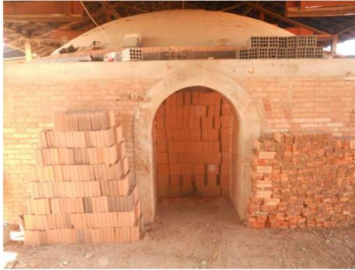
Figura 5 – Calcinação de blocos cerâmicos em forno de barro (SANTIS, 2012)
