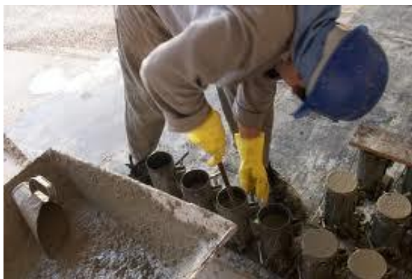
Figura 25 – Moldagem dos corpos-de-prova
