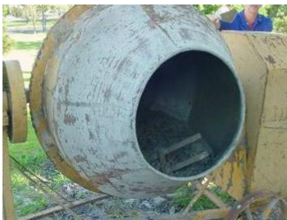
Figura 5 - Mistura dos materiais na betoneira
