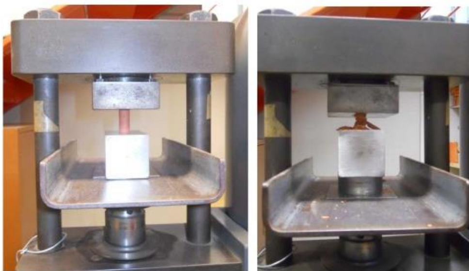
Figura 18 – Corpo-de-prova sendo rompido no ensaio de compressão
