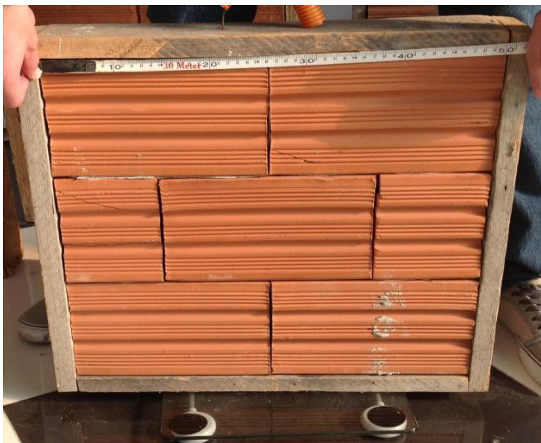
Figura 16 – Ensaio de pesagem do conjunto tijolo e argamassa (VERBAMFIX, 2013)
