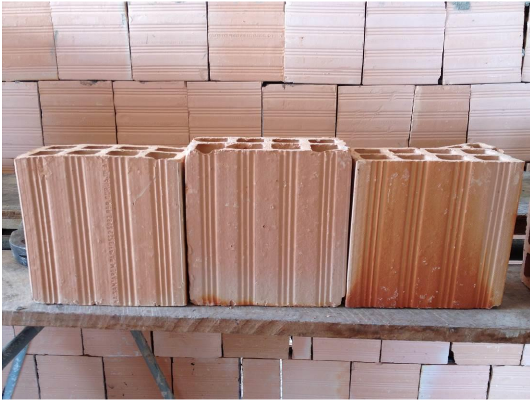
Figura 18 – Falta de uniformidade dimensional dos tijolos cerâmicos
