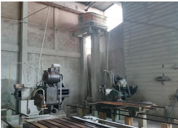
Figuras 11 e 12 – Máquinas de corte a úmido e sistema de abastecimento de água.
