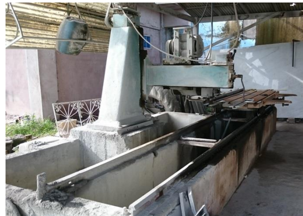
Figuras 11 e 12 – Máquinas de corte a úmido e sistema de abastecimento de água.
