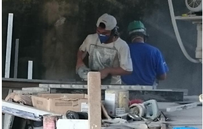
Figura 9 e 10 – Trabalhadores realizando acabamento a úmido.
