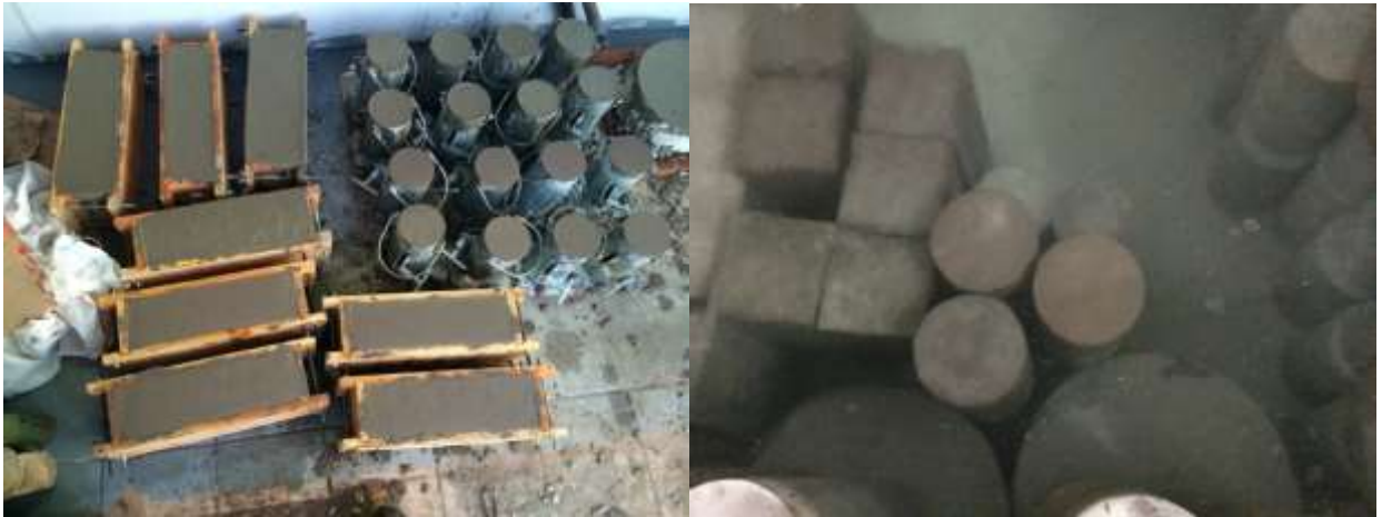
Figura 15 – (a) Corpos-de-prova prismáticos e cilíndricos imediatamente após moldagem; (b) Corpos-de-prova em cura saturada de água com cal hidratada
