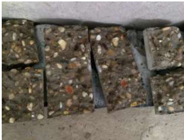
Figura 18 – Concreto de seixo após rompimento à tração na compressão diametral
