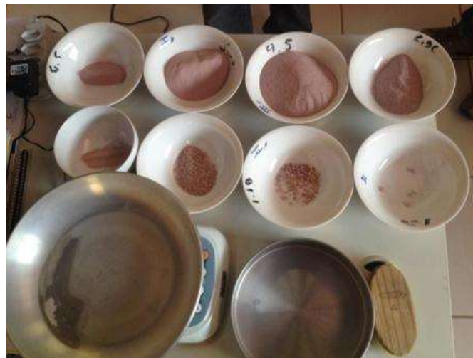
Figura 09 - Areia retida nas peneiras da série normal para pesagem
