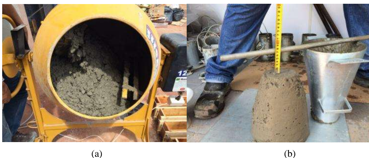
Figura 14 – (a) Mistura dos materiais em betoneira elétrica e (b) Ensaio de abatimento ou “slump test”
