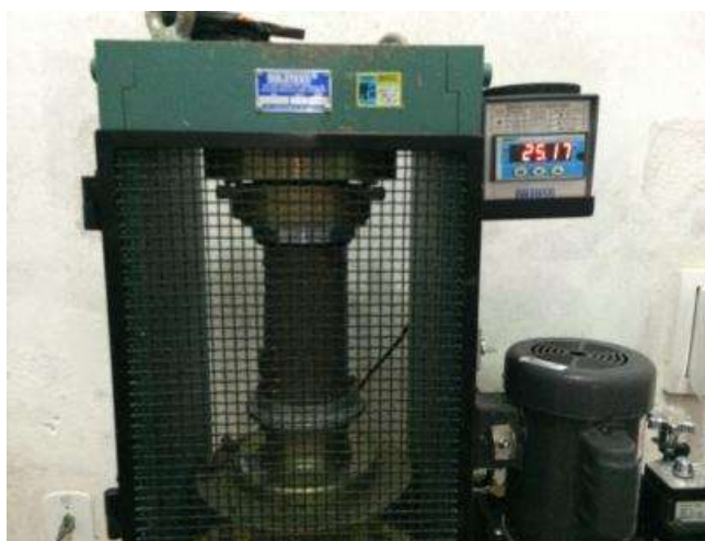
Figura 16 – Ensaio de compressão axial executado em prensa hidráulica
