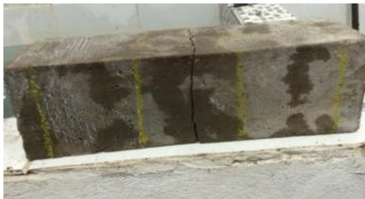
Figura 19 – Corpo-de-prova prismático rompido à tração na flexão
