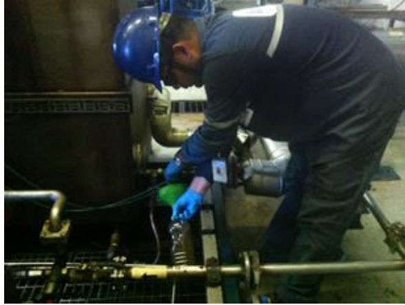
Figura 4.15: Amostragem na entrada da ETE (UTE Manauara, 2013).
