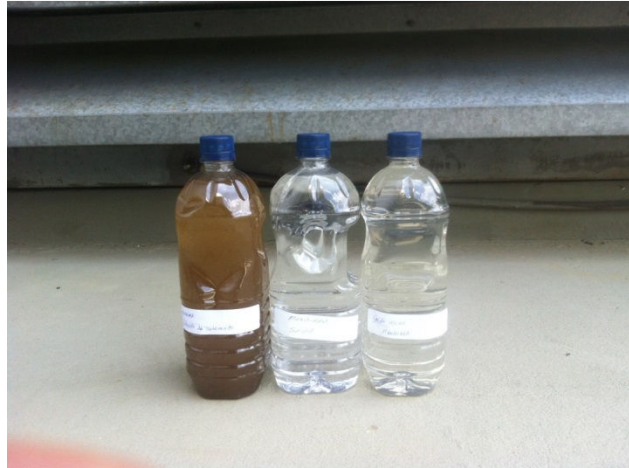
Figura 4.18: Amostras retiradas da entrada e saída da ETE e da saída da usina respectivamente (UTE Manauara, 2013).
