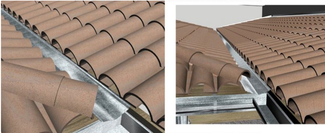
Figura 15- Calha do tipo água furtada. Fonte: algetalurgica, 2014.
