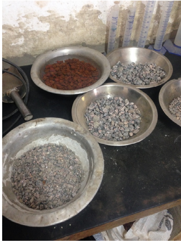
Figura 5.3 classificação dos agregados para os ensaios
