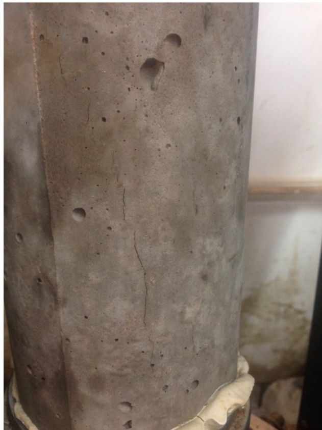
Figura 4.1 - corpo de prova depois de submetido à compressão axial
