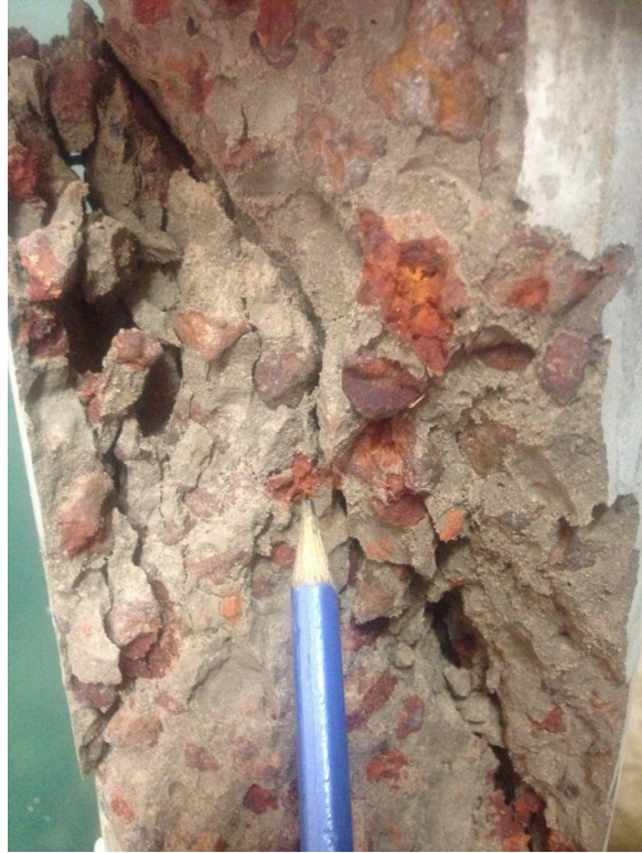
Figura 5.2 figura mostra rompimento do agregado lateritico no cp de 28 dias
