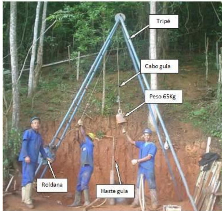
Figura 3.3 - Equipamento para sondagem à percussão SPT. Fonte: servissondagem (2014).
