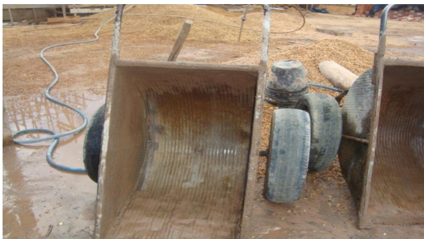
Figura 21 – Transporte de concreto em Girica.
