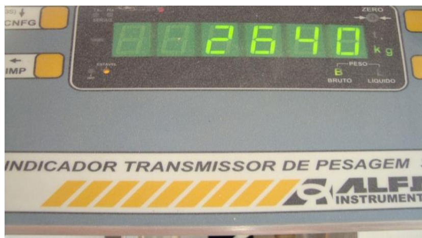
Figura13 – Indicador digital de leitura da célula de carga acoplado a uma balança.
