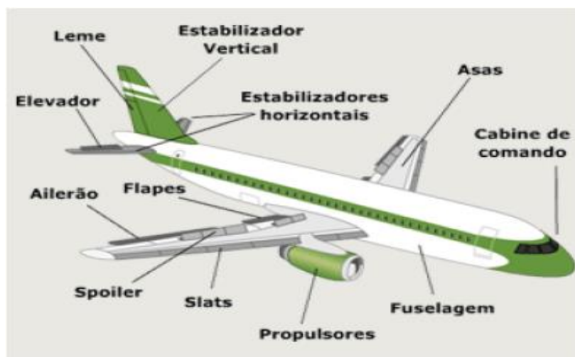
FIGURA 2.6– Propulsores e áreas fixas e móveis de uma aeronave que geram ruído. Fonte: Portal Educacional (2013).
