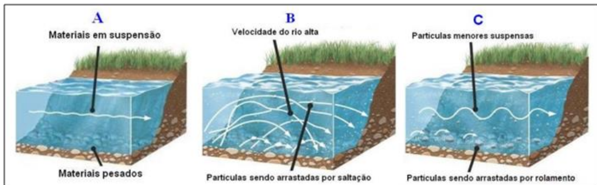
Figura 8: tipos de transportes de materiais: (A) Transporte por suspensão: É a principal forma de transporte de materiais muito pequeno como argila; (B) Transporte por saltação: Esse é o tipo de transporte comum para partículas de média granulometria como areia. Ocorre por um movimento em que uma partícula está no fundo do rio é levantada e depositada mais adiante; (C) Transporte por rolamento (ou arrasto): Transporte que envolve materiais de grande granulometria como cascalho e seixo.
