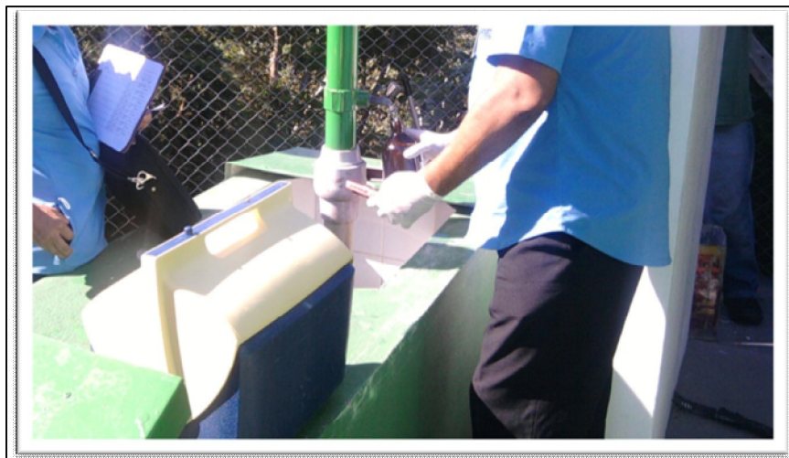
Figura 4.14 – Coleta do efluente tratado para análise Fonte: MARTINS, A. G. (2013).
