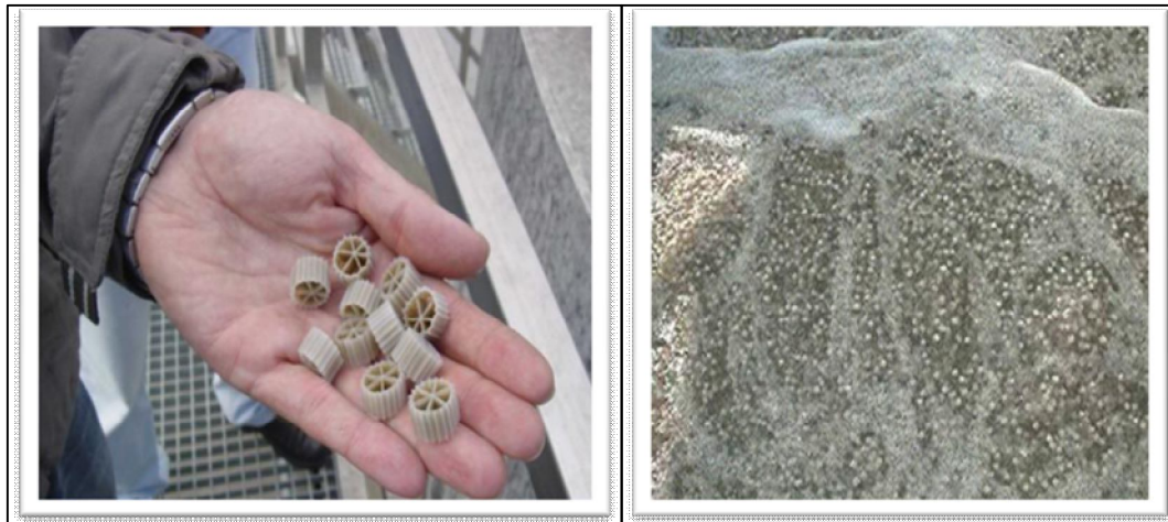
Figura 2.5 – Processo de aeração com MBBR Fonte: MARTINS, A. G. (2013).
