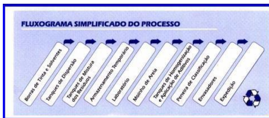
Figura 6 – Fluxograma do processo do Reprocessamento da Borra de Tinta Fonte: Catálogo RESICOR, 2005.
